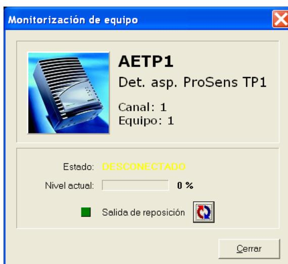
☞ El detector comunica periódicamente con el interface, y hasta que no se ha identificado el tipo de detector no se puede acceder al equipo. Este tiempo se puede minimizar limitando el rango de equipos que comunican en el bucle.
