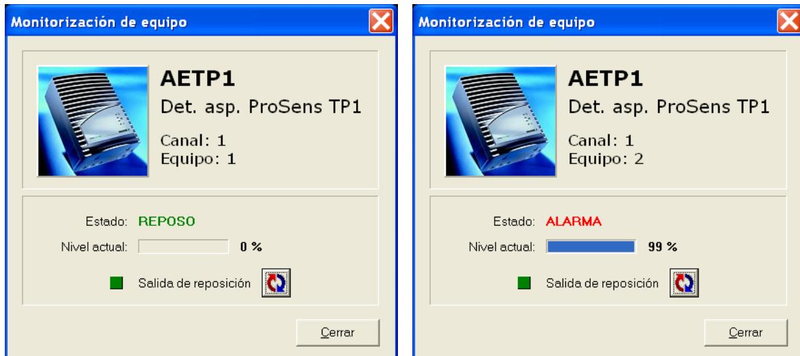
**Si el detector se encuentra en estado de alarma, es posible hacer una reposición remota actuando sobre el botón de reposición, y volviéndolo a desactivar cuando pase a reposo.**
